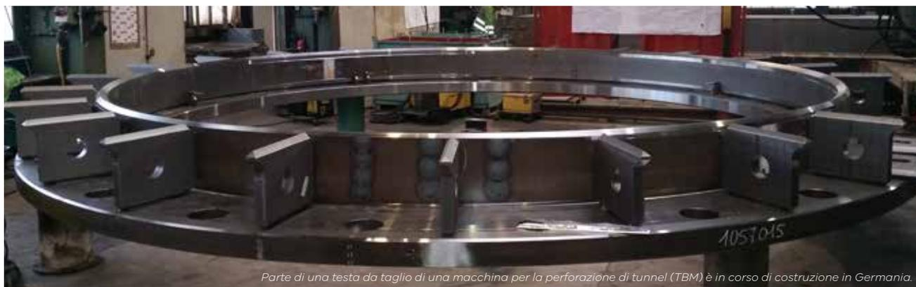
Parte di una testa da taglio di una macchina per la perforazione di tunnel (TBM) è in corso di costruzione in Germania.
