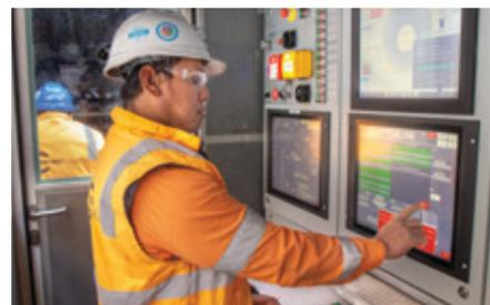
TBM 由一名操作员控制，并由多达 20 人的团队进行维护。该机器将 24 小时全天候持续在地下进行掘进，直到挖通至其工程目的地，之后会被收回。一旦掘进完成、衬砌安装完毕，就可以开始为新隧道进行配备公用事业设施、铺设铁轨和其他设备等复杂施工。
